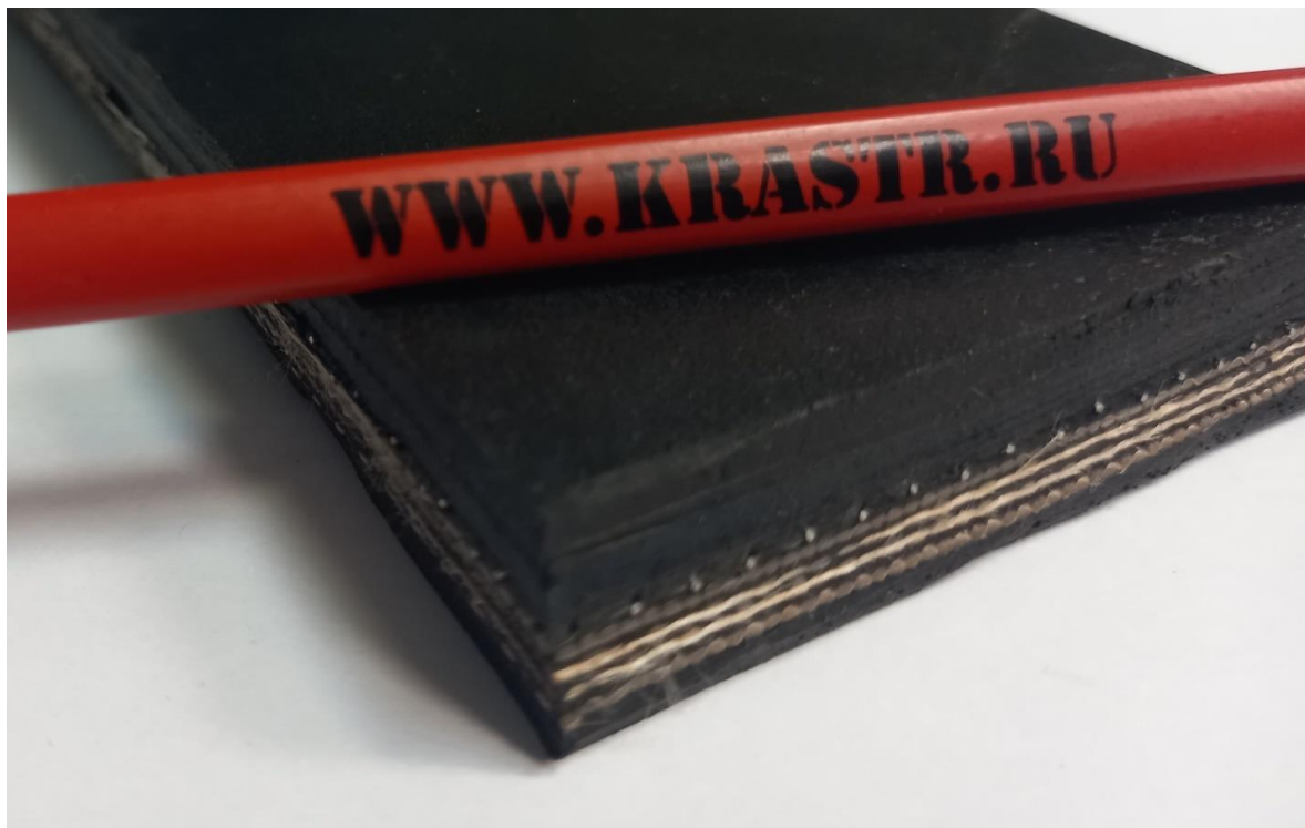
Рис. 3. Конвейерная лента с брекером из тканой оцинкованной сетки
