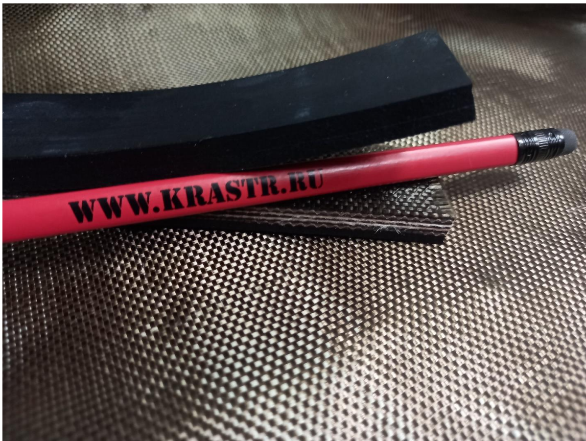
Рис. 1. Конвейерная лента с брекером из базальтовой ткани
