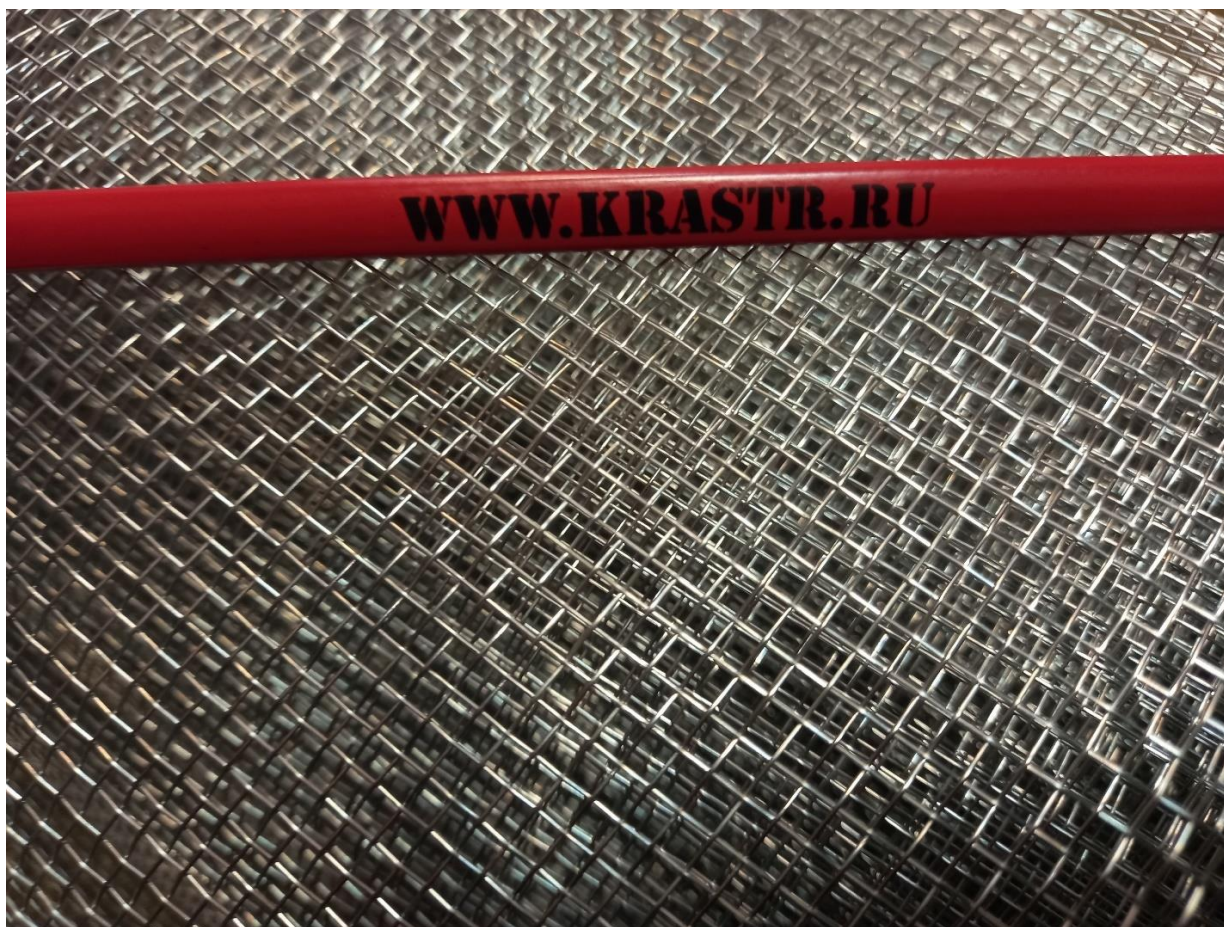
Рис. 2. Тканая оцинкованная сетка, применяемая при изготовлении металлического брекера
